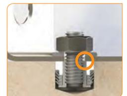
Per una corretta applicazione si raccomanda che il perno sia avvitato su tutto il tratto utile di filetto e che l'elemento da fissare sia a contatto con la boccola metallica dell'inserto Keep-Nut®.
