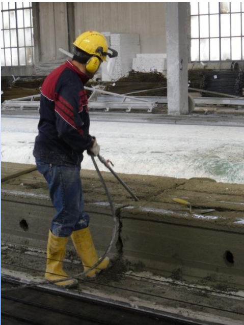
Banchi di getto ad armatura pretesa da 1.20 L120 -150 m
