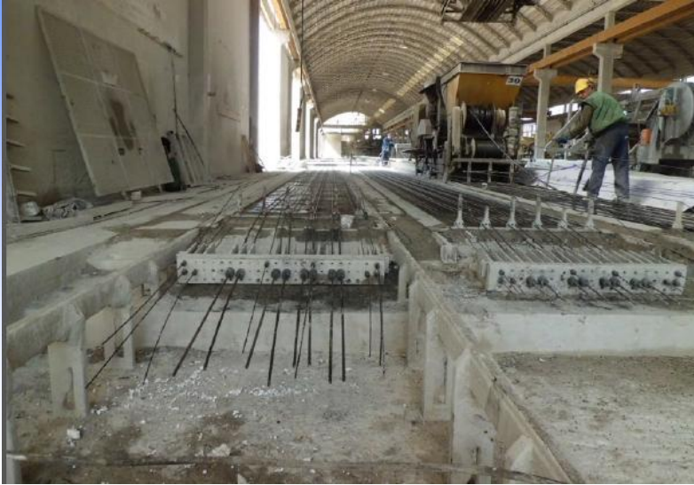
Banchi di getto ad armatura pretesa da 1.20 L120 -150 m
