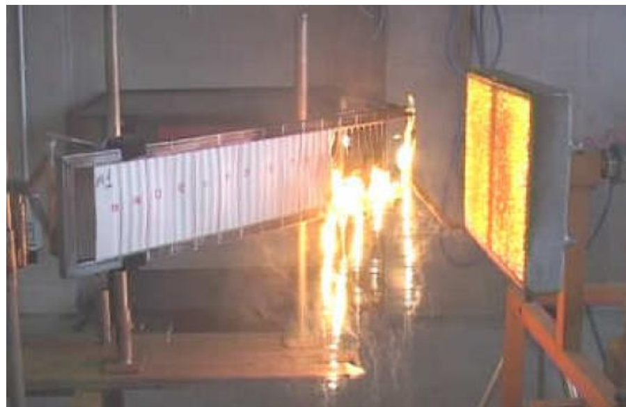
Prova di reazione al fuoco al pannello radiante «effetto di gocciolamento di materiali termoplastici»
