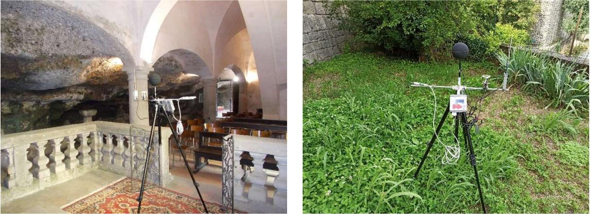
Fig. 7. Stazione microclimatica. Misure all'interno ed all'esterno dell'Ipogeo
