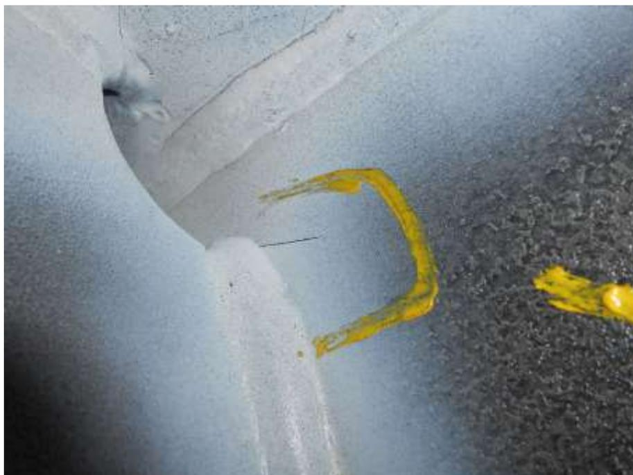
Figura 7 Cricca di fatica all'incrocio tra elementi di irrigidimento, rilevata con metodo di controllo magnetoscopico, tecnica con giogo magnetico e lacca bianca di contrasto
