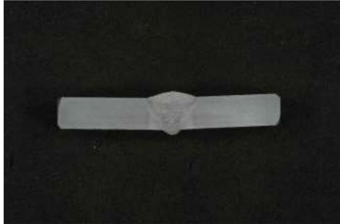
Figura 3 Giunto testa a testa a completa penetrazione (CJP)
