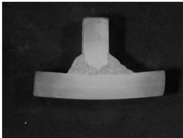
Figura 4 Giunto a T a completa penetrazione (CJP)
