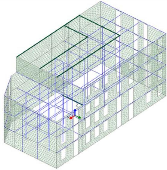
Esempio di edificio calcolato tramite approccio FEM
