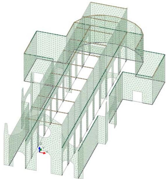
Esempio di edificio irregolare calcolato tramite approccio FEM
