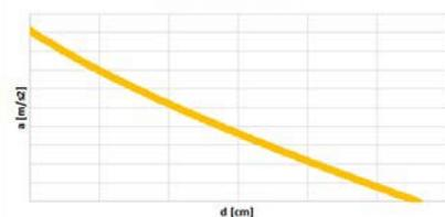
Dettaglio della curva di capacità prodotta da una analisi non lineare
