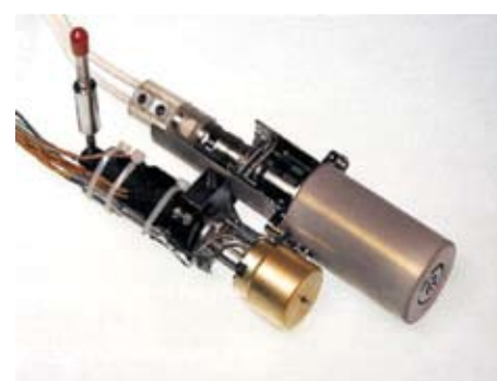
3 Resitogetto ad idrazina
