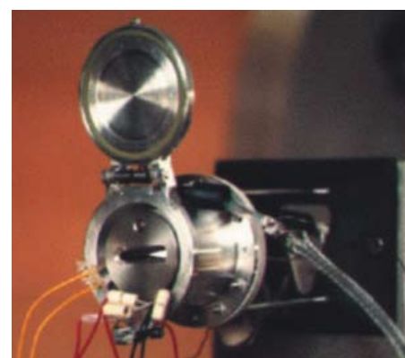
8 - Propulsore FEEP assemblato
