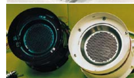
10 Fotografie di propulsori RIT 10 I propulsori elettromagnetici
