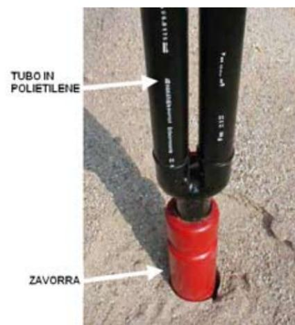
Figura 8 - Particolare di sonda a semplice U.
