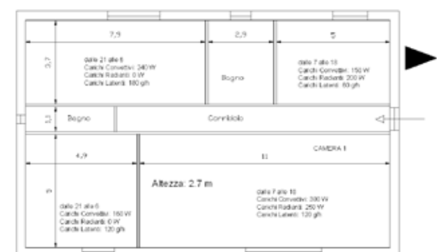
Figura 2 - Schematizzazione dell'edificio considerato (dimensioni in metri).
