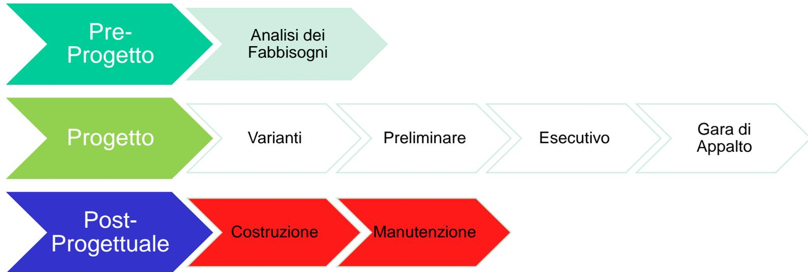
Questo schema processuale nel BIM si applica per definire i modelli ed i c.d. LOD (Level of Development), i MEP (Mechanical/Eletrical/Plumbing), ed in generale, i deliverables che si intende perseguire e misurare con il Project ed il Facility Management.
