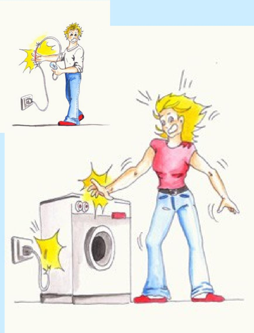
E' il contatto tra la persona e parti parti conduttrici di impianto elettrico o di utilizzatore elettrico che non sono ordinariamente in tensione, ma che possono andare in tensione a causa di un guasto.
