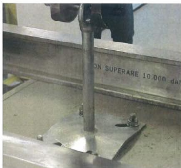
Trazione : piegamento piastra di base.
