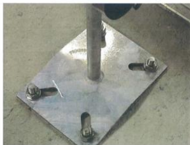
Trazione : piegamento piastra di base.
