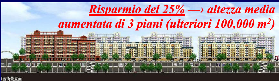
Nuovo centro residenziale di Pechino: 50 edifici isolati (7-9 piani, 480·000 m 2 ) su un'unica sottostruttura di 2 piani (1500 m · 2000 m), con tutte le infrastrutture
