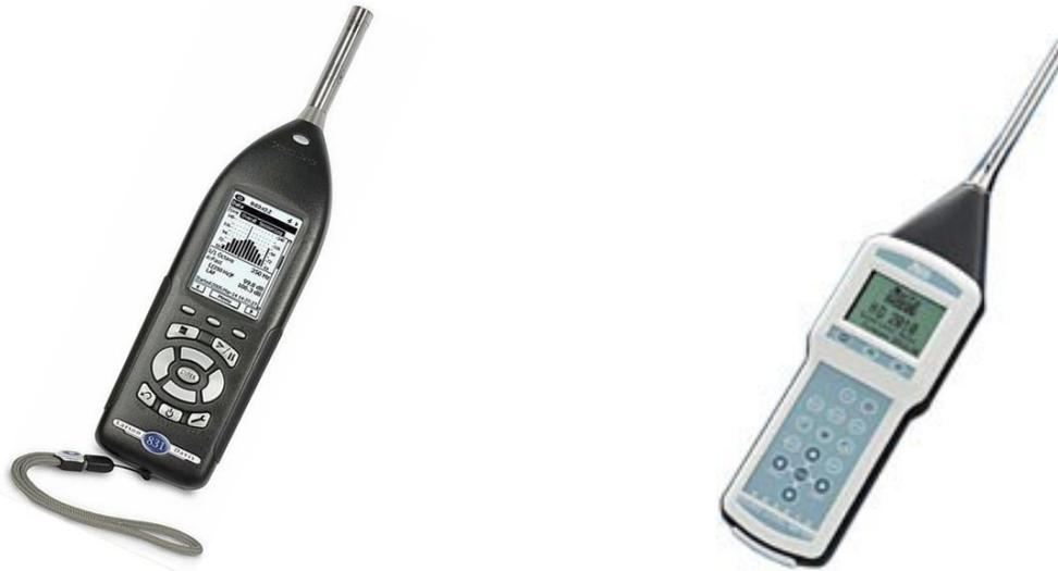
**Strumentazione di Classe 1, conforme alla CEI EN 61672-1** (che sostituisce le norme ritirate CEI EN 60651/82 e CEI EN 60804/99, ancora valide finché ne è possibile la taratura, ora biennale).
