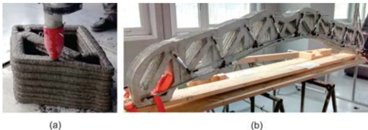
Fig A. Stampa 3D del calcestruzzo: (a) Processo di deposizione della malta cementizia; (b) Struttura stampata in 3D costituita da elementi di forma complessa assemblati con rinforzo esterno.
